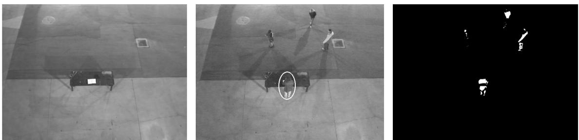
Figure 38, 39, 40 – Rimozione del background
